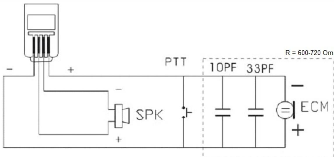
Разъем для подключения – RG-9, к внутренним контактам должен быть подключен громкоговоритель, к внешним подключается микрофон сопротивлением 600-700 Ом.
